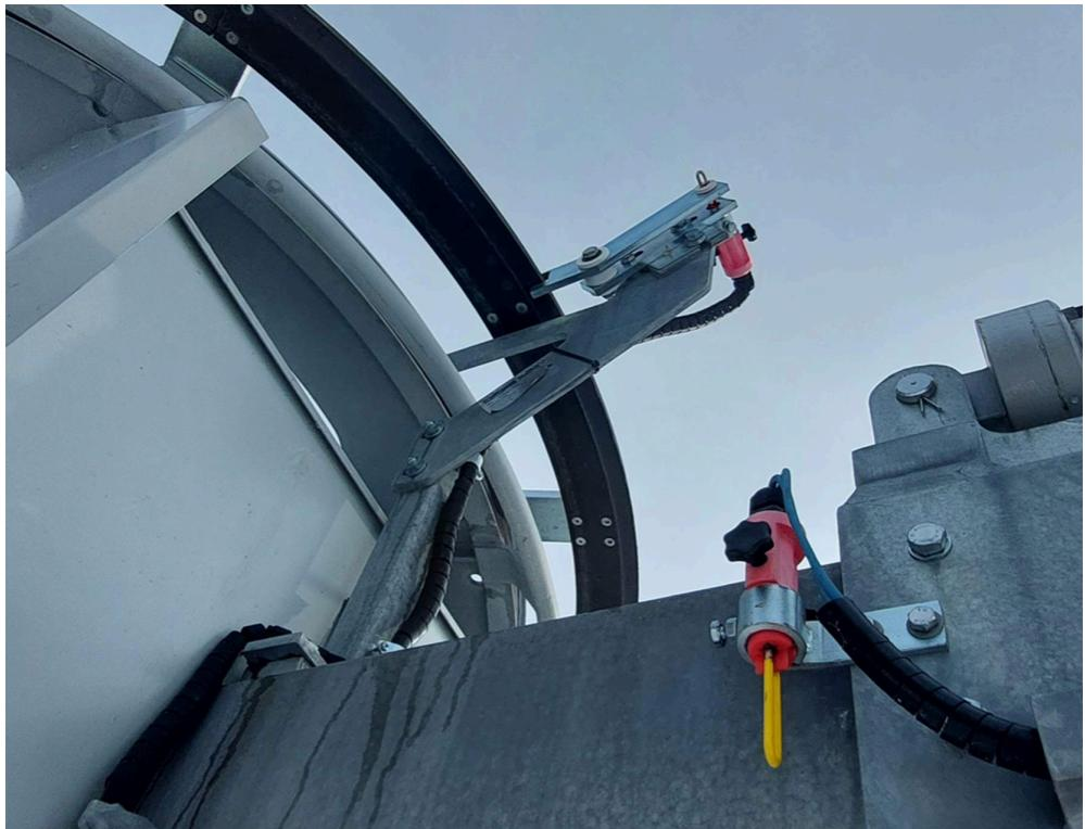
Im Bild zu sehen eine Seilscheibe mit Überwachung, die im Falle einer mechanischen Störung sofort einen Nothalt auslöst.
